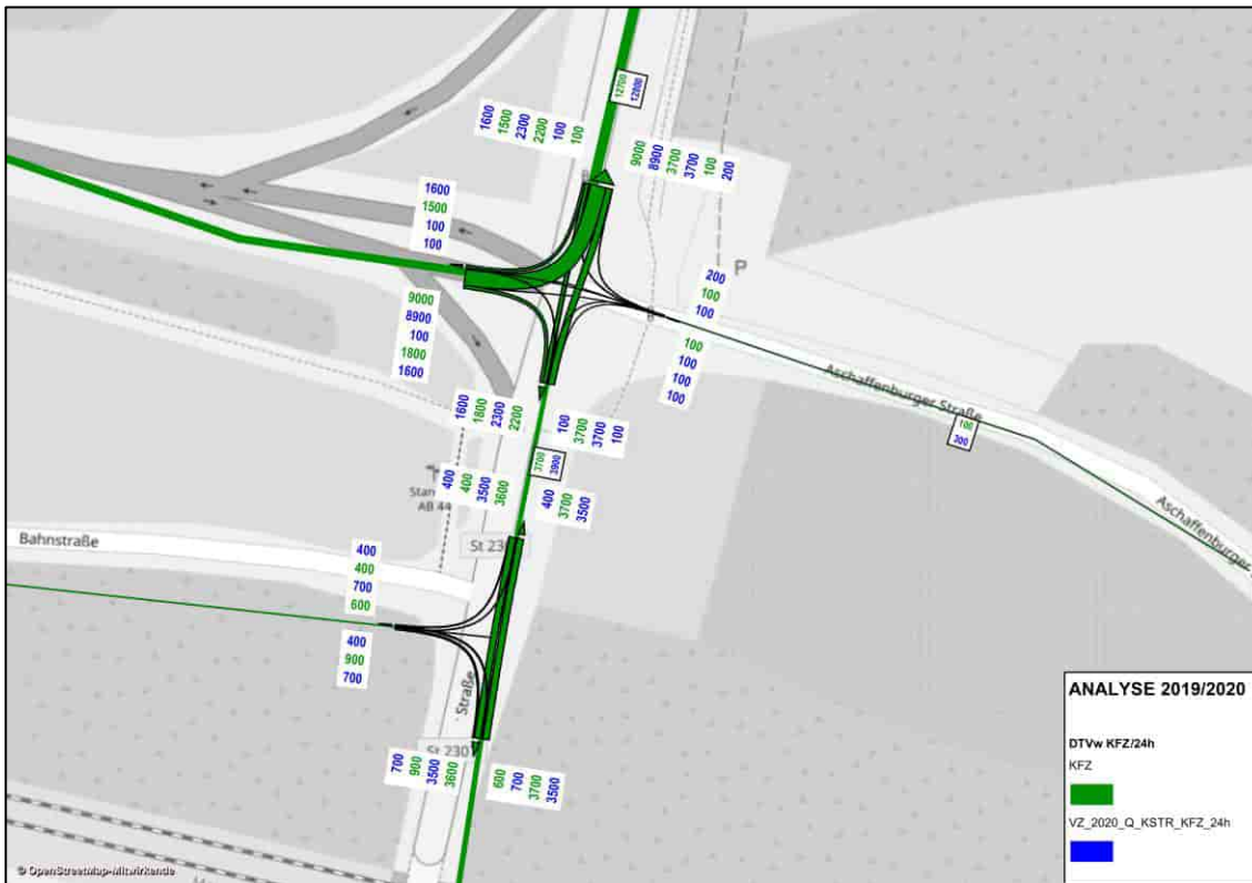
Abbildung 18: Analyse 2019 / 2020 – K25 und K26 – St 2307 / Rampe A 3 Hösbach Richtung Würzburg und St 2307 / Bahnstraße
